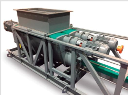
**N.Mac® em montagem em conjunto com uma bomba NEMO® para trituração de resíduos de peixe. Instalado no Equador em uma fábrica de proteína de peixe.**
